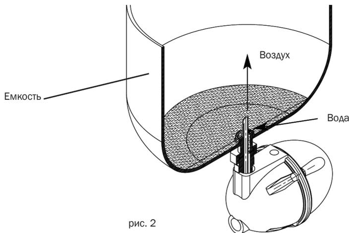
Автоматический конденсатоотводчик, подсоединенный входным штуцером к оборудованию (компрессор, сепаратор, осушитель и др.)
