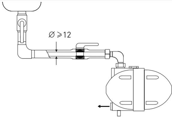
Если слив выполняется в линии, труба должна быть ориентирована так, чтобы обеспечить возможность отвода потока воздуха и накопления конденсата в нижней части
